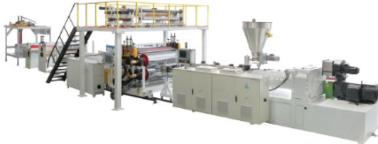
SPC地板挤出生产线-1. 压光机。它是不粘的PVC装饰膜，磁粉制动器。薄膜由气胀辊压紧，四工位工作。采用压平辊，使PVC装饰膜光滑平整，无任何气泡。采用红外线调膜系统和张力调节系统，使薄膜保持平整、光滑、不变形。2. 堆垛机。抓卸板机械手是由真空吸盘装置、升降装置和移动装置组成。它用于垂直升降运动和水平运动的复合运动，用于抓取成品板材和型材以及排列空白板材。该装置实现了板材输送的自动化。3. 冷却架。4. 牵引装置。工作速度可由\*\*的变频器调节。输送皮带由进口材料制成。镀锌带辊5毫米传送带我们采用五辊压光机系统，这是一种特殊设计。内蒙古品质SPC地板挤出生产线方案设计
